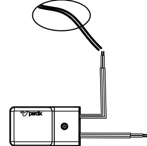
**3. Schliessen Sie das AC-Kabel des Treibers an das Stromnetz an.**
