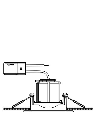
**4. Verbinden Sie den DC-Anschluss des BARON 2.0® mit dem DC-Anschluss des Treibers.**
