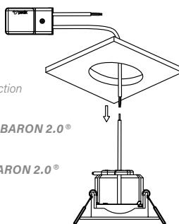
**2. Lösen Sie das AC-Kabel des Treibers von dem Stromnetz.**
