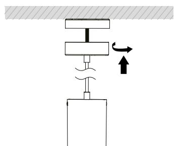
Baldachin an der Decke schliessen und so die Installation der Leuchte fertigstellen.
